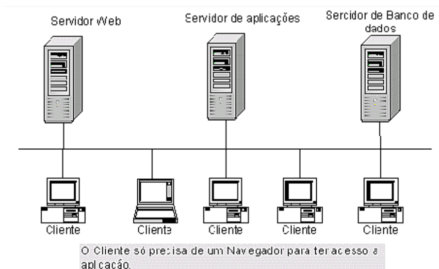
Figura 4 - O Modelo de desenvolvimento em quatro camadas.
